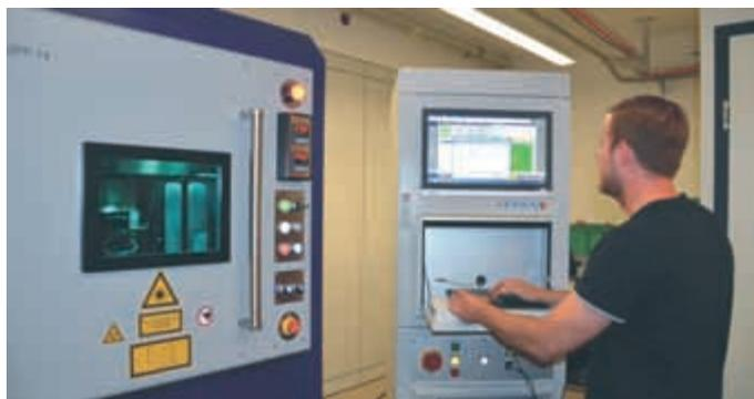
*Auf dem Prinzip der Zwei-Photonen-Polymerisation (2PP) arbeitet eine von TETRA entwickelte Laseranlage zur Erzeugung von 3D-Nanostrukturen. Foto: wr*
