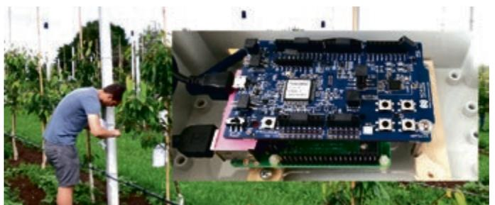
Vom IMMS am Lehr- und Versuchszentrum Gartenbau Erfurt installierte Funkensensormodule, mit denen Lufttemperatur, Luft- und Blattfeuchte gemessen werden. Fotos: IMMS
