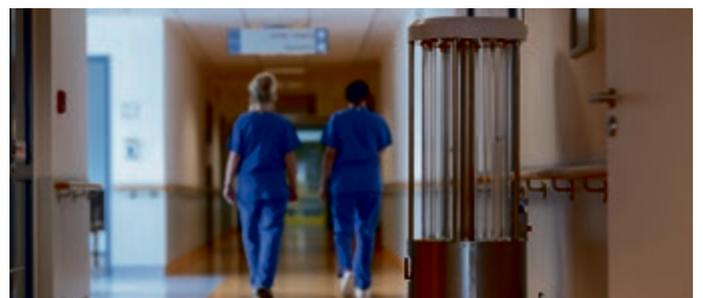
*Der Desinfektionsroboter Sterybot®, entwickelt von der MetraLabs GmbH, kann ganze Klinikbereiche mit UV-Licht desinfizieren. Foto: MetraLabs*
